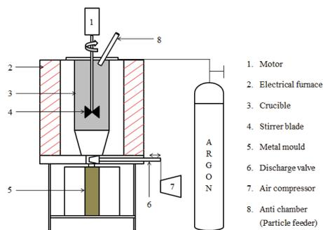
Figure 1 Bottom pour liquid metal processing furnace.
